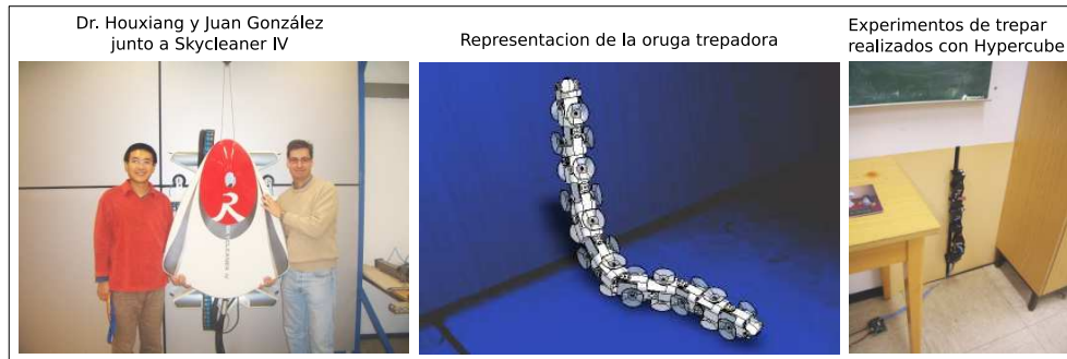
Figura 1.2: Robot trepador Skycleaner (izquierda). Prototipo de la oruga trepadora que usa ventosas pasivas para agarrarse (centro). Experimentos de trepar realizados con Hypercube (derecha)
