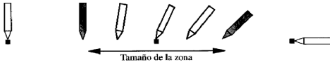
Figura 4 Si la posición del medio fuera un punto de paso, la ejecución del programa tendría este aspecto
