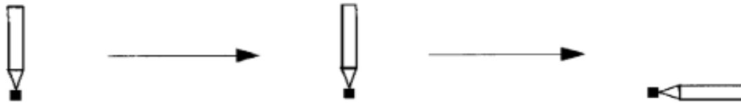
Figura 2 Tres posiciones han sido programadas; la última con una orientación de herramienta diferente.
