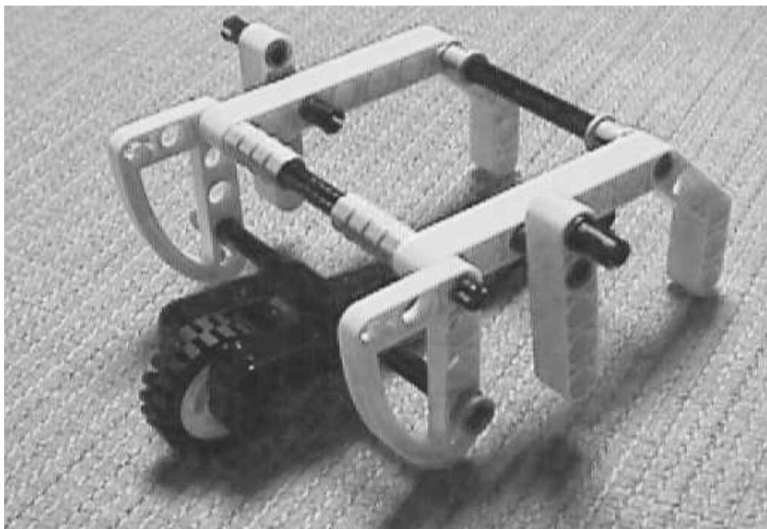
Figura 8: Foto de la estructura final sin los motores.
