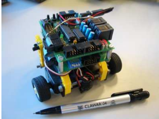
Figura 3. El microbot Skytritt, que utiliza la tarjeta Skypic como “cerebro”
