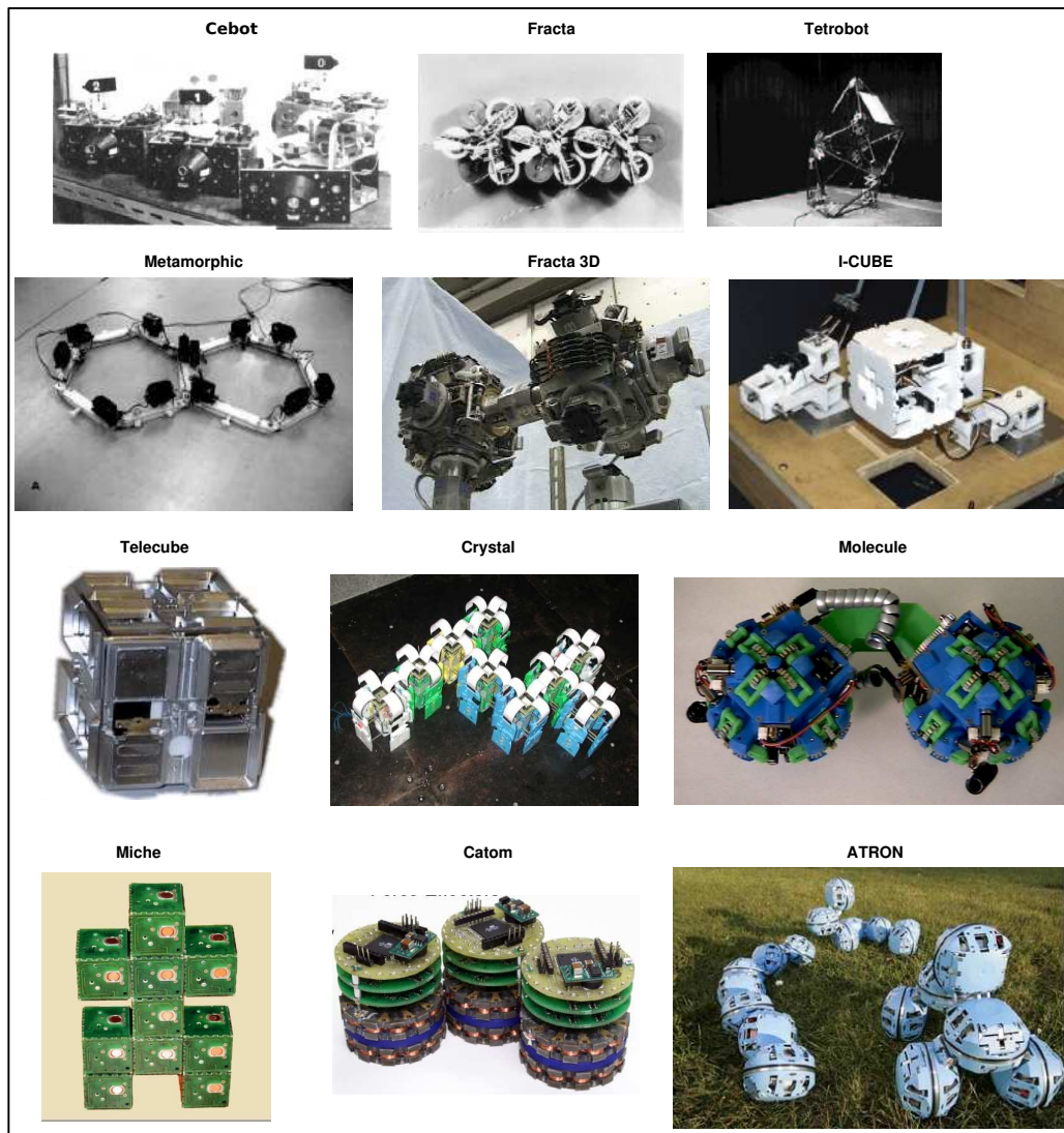
Figura 2.17: Diferentes robots modulares de tipo retículo
