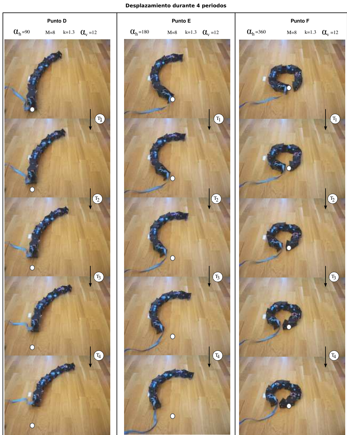
Figura 7.64: Experimento 34: Desplazamiento en trayectoria circular de Hypercube, en los puntos D,E y F
