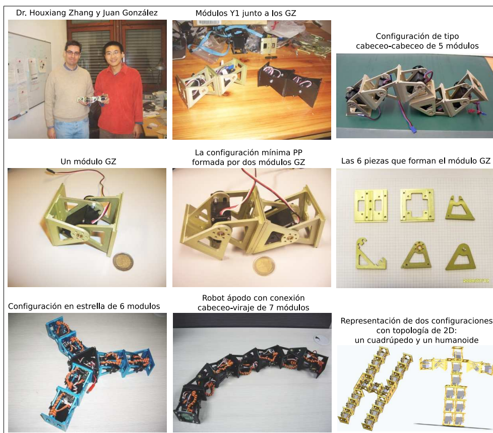
Figura 8.1: La nueva generación de módulos GZ-I
