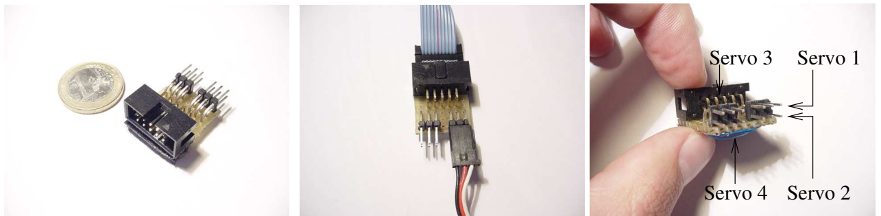
Figura 3.10: Placa pasiva pct-servos, para la conexión de los servos de los módulos a un cable de bus. En la foto de la izquierda se aprecia el reducido tamaño, necesario para entrar dentro de un módulo. En la foto central hay conectado un servo y el cable de bus. En la foto de la derecha se indica dónde se conecta cada uno de los servos, considerando que el 1 es el de la cola
