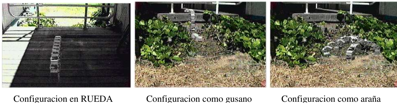
Figura 2.1: Aplicación de un robot reconfigurable. Según el terreno se reconfigura y utiliza una locomoción diferente
