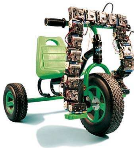
Figura 2.13: El experimento del triciclo, movido por módulos de tipo G1v4
