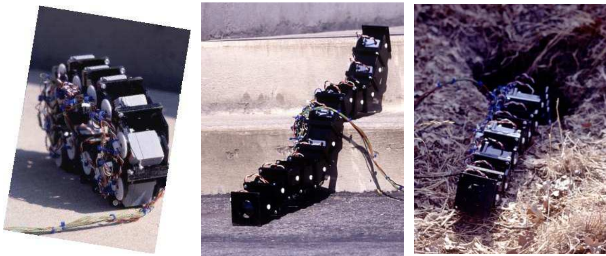
Figura 2.9: Fotos de la primera reconfiguración dinámica de Polybot G1 . En la foto de la izquierda, se está desplazando como una rueda, en la del centro se ha convertido en un gusano que es capaz de descender por unas escaleras y en la de la derecha se está introduciendo en un agujero.
