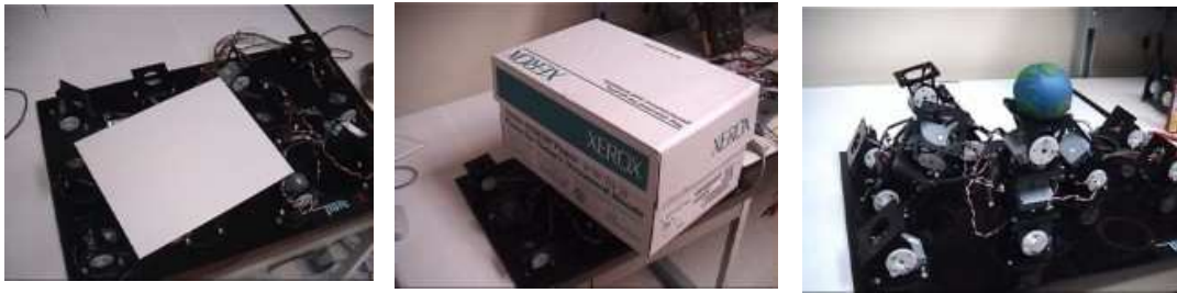
Figura 2.11: Ejemplos de polybot G1 usado para manipular objetos. En la foto de la izquierda está desplazando una hoja. En la central está rotando una hoja y en la de al derecha están pasando una bola de un lado a otro
