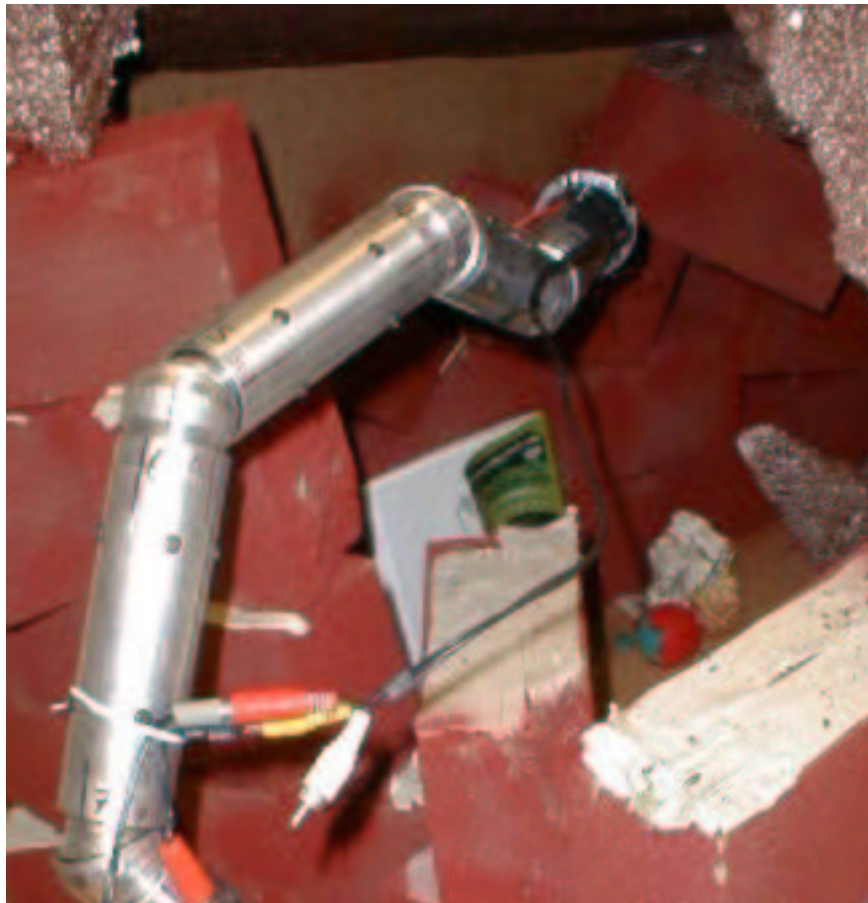
Figura 4: Robot USAR para rescate, CMU
