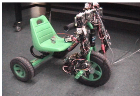
Figura 32: Polybot montando en un triciclo
