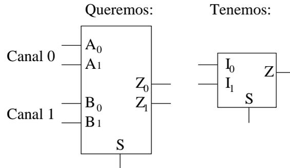
Utilizaremos dos multiplexores de lo que tenemos, uno por cada bit que tengamos en el nuevo canal de salida. Como los canales en el nuevo multiplexor son de 2 bits, necesitaremos 2 multiplexores de canales de 1 bit. Uno de estos multiplexores será al que vayan los bits de menos peso de los canales de entrada y el otro los de mayor peso. Las entradas de selección de ambos están unidas:
