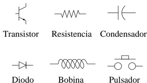
Figura 4.4: Algunos símbolos empleados en la electrónica analógica
