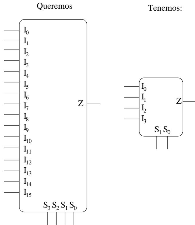
Los conectamos en cascada, para lo cual necesitamos una primera columna de 4 multiplexores de 4 entradas, con entradas  $S_0$  de todos ellos unidos, así como las  $S_1$ . En la segunda fila hay un único multiplexor de 4 entradas:
