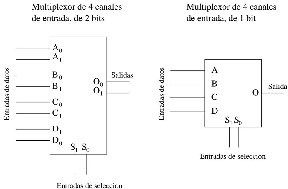
Figura 5.4: Dos multiplexores de 4 canales de entrada
