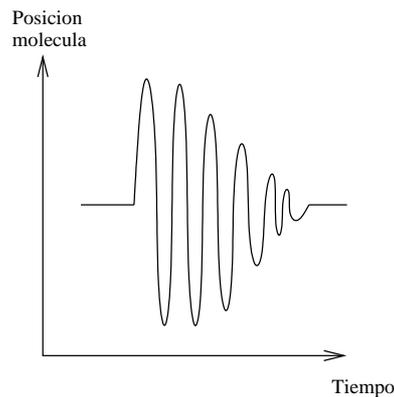
Figura 1.2: Un trozo de una señal acústica
