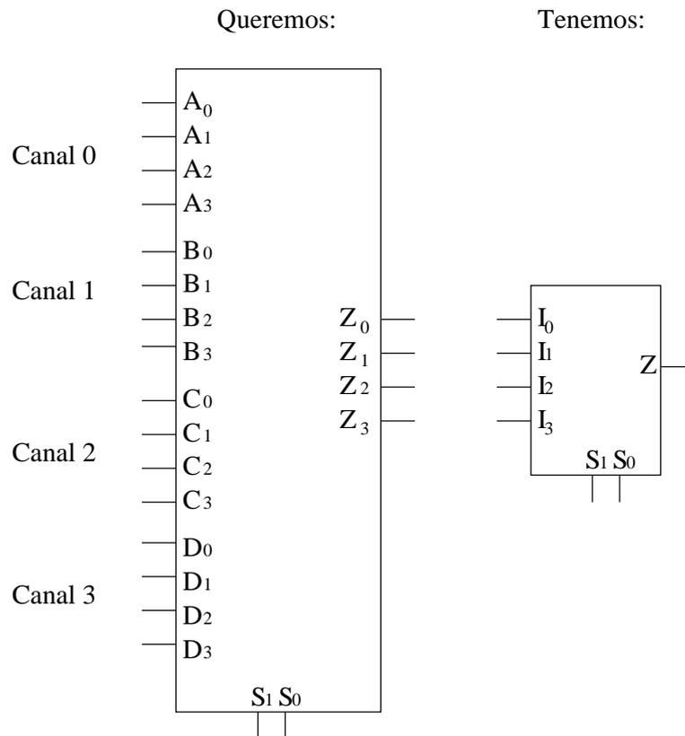
Ahora necesitaremos 4 multiplexores de los que tenemos, a cada uno de los cuales les llegan los bits del mismo peso de los diferentes canales. Por el primer multiplexor entran los bits de menor peso ( $A_0$ ,  $B_0$ ,  $C_0$  y  $D_0$ ) y por el último los de mayor ( $A_3$ ,  $B_3$ ,  $C_3$  y  $D_3$ ). En el dibujo no se muestran todas las conexiones para no complicarlo:
