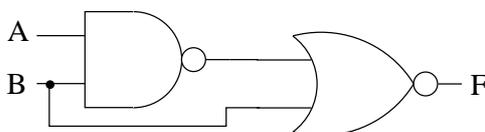
A la salida de la puerta NAND tenemos la expresión:  $\overline{A \cdot B}$ , que se introduce en una de las entradas de la puerta NOR, y por la otra B. El resultado es:
