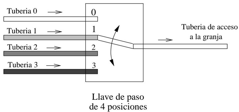
Figura 5.2: Sistema de agua de 4 tuberías
