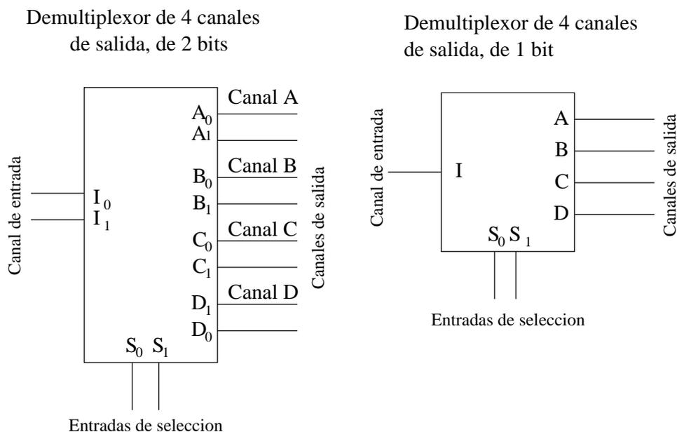
Figura 5.10: Dos demultiplexores de 4 canales de salida
