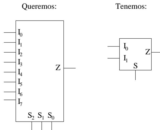
La solución es **conectarlos en cascada**. Primero colocamos una columna de 4 multiplexores de dos entradas, para tener en total 8 entradas. Todas las entradas de selección de esta primera columna se unen. Por comodidad en el dibujo, esto se representa mediante una línea vertical que une la salida  $S$  de un multiplexor con el de abajo.
