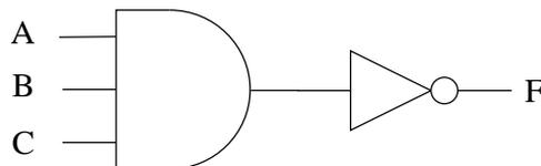
El circuito está constituido por dos puertas, una **AND de tres entradas** y un **inversor**. A la salida de la puerta AND se tiene el producto de las tres variables de entrada  $A \cdot B \cdot C$  y al atravesar el inversor se obtiene la expresión final de F, que es:
