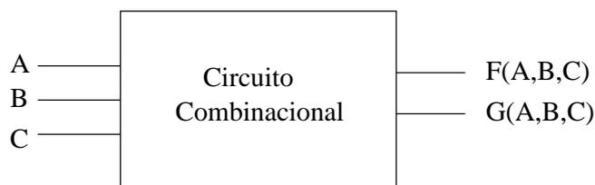
Figura 4.3: Un circuito combinacional de 3 entradas y 2 salidas
