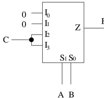
¿Se podría implementar esta función con un multiplexor con entrada de validación?. Si nos fijamos en la función F vemos que podemos sacar factor común en A:
