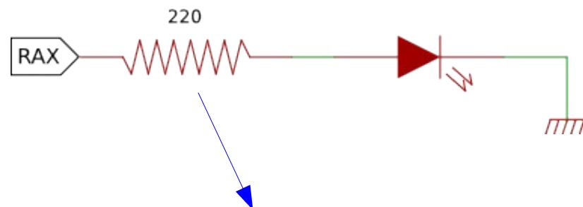
Conexión de leds a los pines RA0-RA3,RA5
