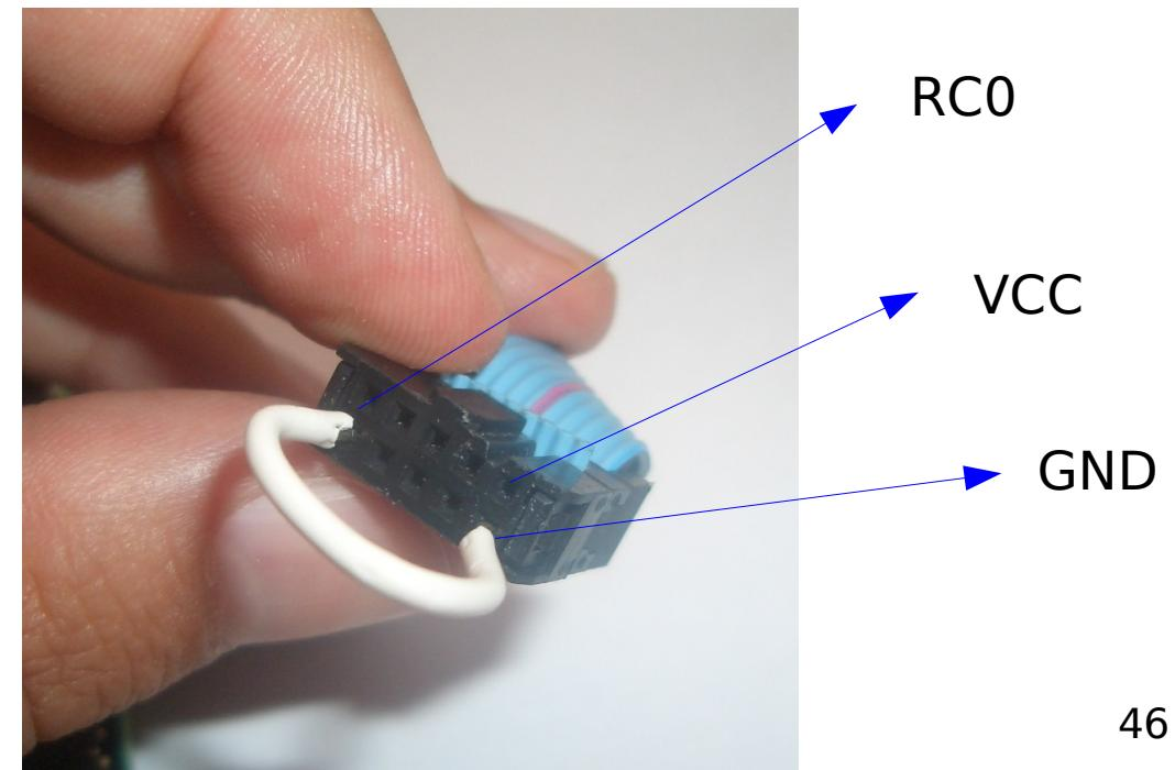
Para probarlo podemos usar un cable para conectar RC0 con GND o VCC
