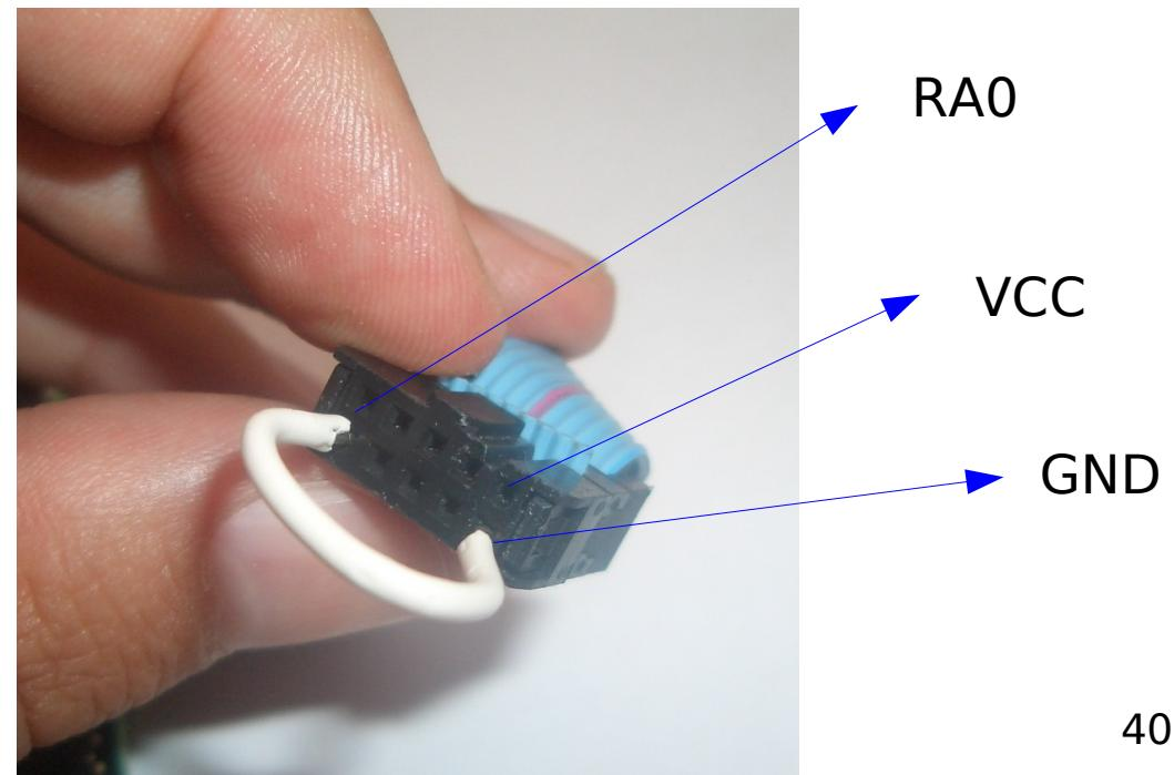
Para probarlo podemos usar un cable para conectar RA0 con GND o VCC
