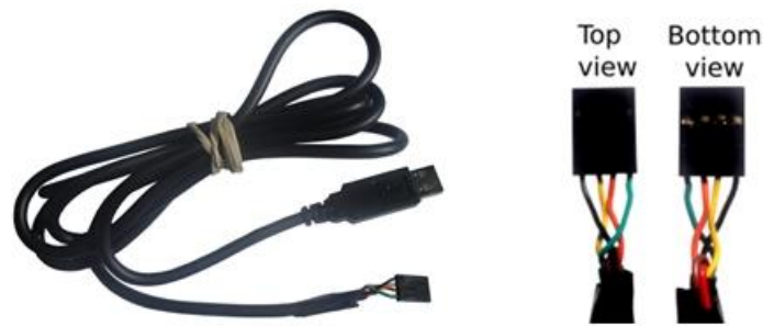
Figura 3. 10: Conector cable USB-serie de FTDI (modelo TTL-232R-5V) modificado para uso con SkyMega [23]
