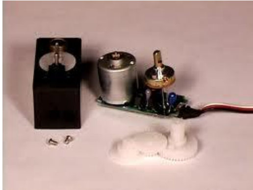
Figura 3. 5: Circuito interno de un servomotor
