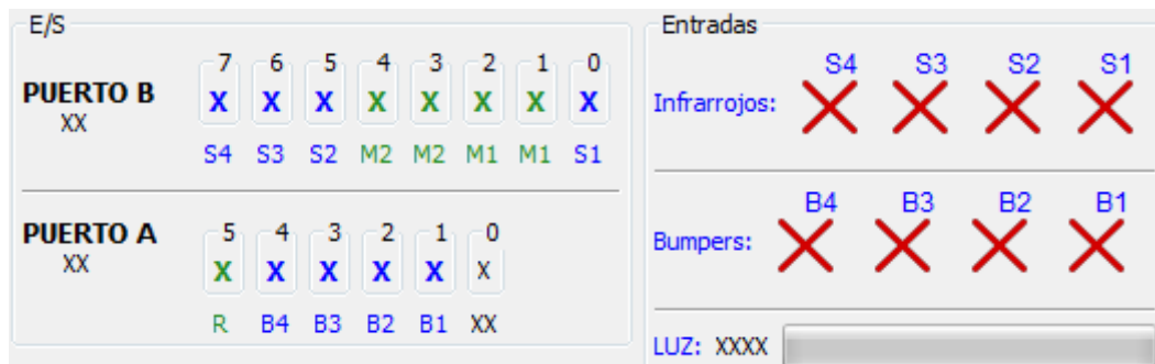
Detalle de los sensores en modo desconocido (por fallo de conexión)
