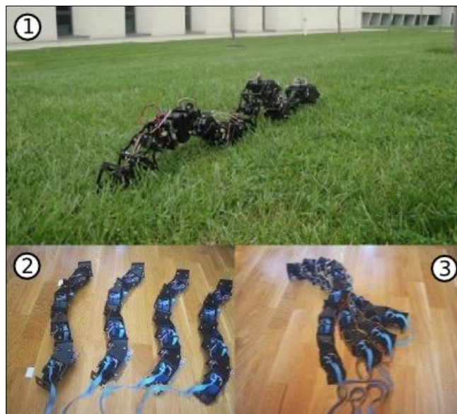
Fig. 11. Experimentos de locomoción. 1) Locomoción en exteriores de un robot de 12 módulos MY1. 2) Superposición de imágenes del desplazamiento lateral de un robot con conexión cabeceo-viraje de 8 módulos. 3) Mismo robot realizando una rotación en sentido anti-horario
