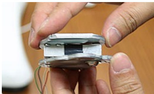
Figura 6.2. Vista de los sensores de deformación utilizados en la Wii Balance Board
