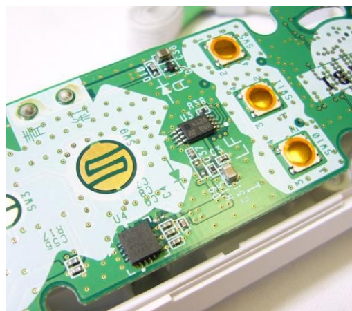
Figura 3.3. Chip ADXL330 integrado en la placa del Wiimote
