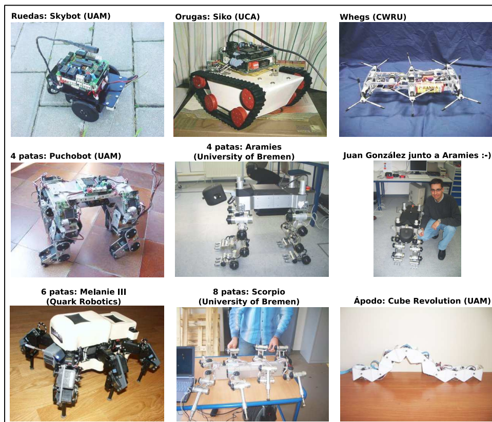
Figura 2.1: Ejemplos de robots con diferentes efectores para la locomoción terrestre
