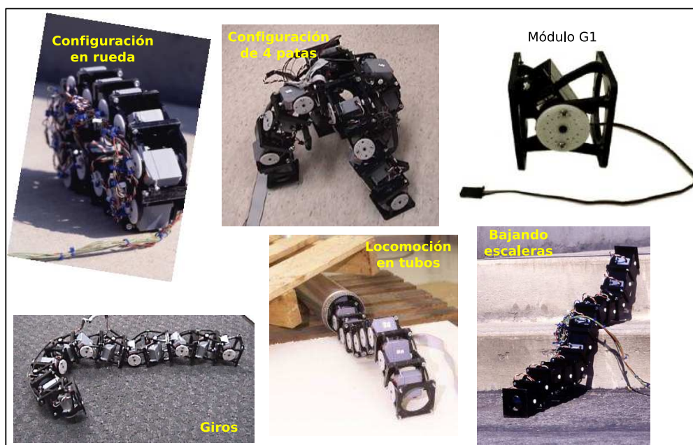
Figura 2.10: Polybot. Diferentes configuraciones de Polybot G1 (Fuente: Web del PARC)
